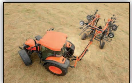
El cabezal permite giros de hasta 80°.
