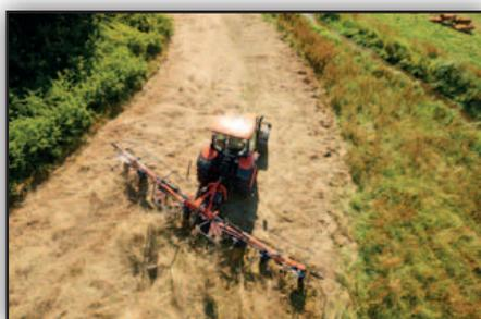
*Con el sistema de esparcido en cabeceras el forraje siempre queda dentro del campo. El volteador se desplaza hidráulicamente a dicha posición y evita lanzar el forraje más allá de los lindes de la parcela.*
