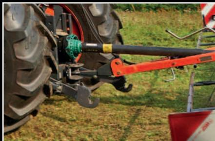
Acoplamiento al enganche de remolque.
