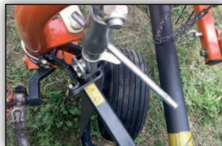
Simple ajuste en tres posiciones del ángulo de esparcido para adaptarlo al volumen y condiciones del forraje.
