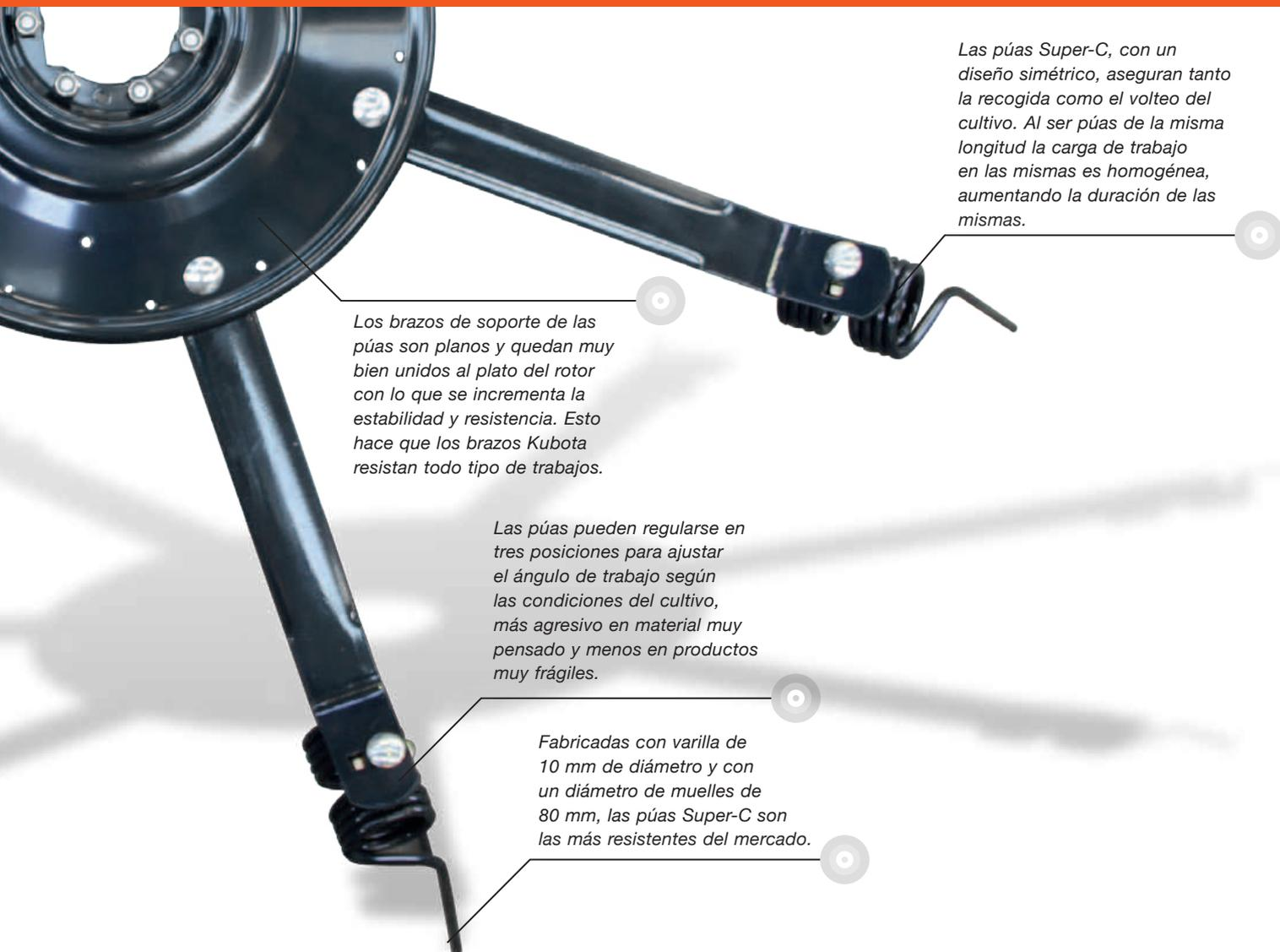
Las púas Super-C, con un diseño simétrico, aseguran tanto la recogida como el volteo del cultivo. Al ser púas de la misma longitud la carga de trabajo en las mismas es homogénea, aumentando la duración de las mismas.
