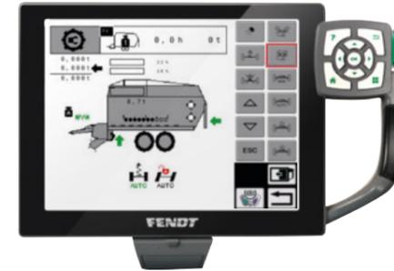
Steuern Sie die Stirnwand und das Schneidwerk direkt über Ihr Terminal. Auch die Pick-Up und die Knickdechsel lassen sich bequem von hier einstellen.
