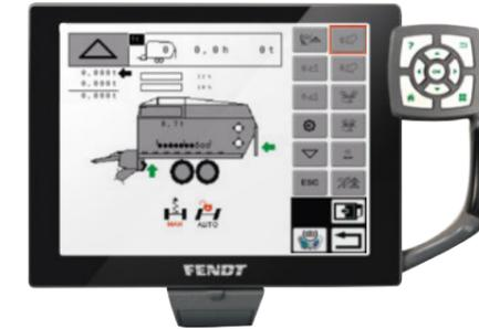
Mit der Abladeautomatik stellen Sie die Weichen für die optimale Entleerung. Stellen Sie die Kratzbodengeschwindigkeit individuell ein.
