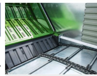
Zum Schutz des Rotors vor Korrosionen und Verschmutzung im Maisensatz hat der Fendt Tigo eine Maiskanalabdeckung, die sich schnell und werkzeuglos einbauen lässt.
