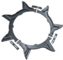
Die Rotorzinken sind in drei Elemente aufgeteilt und können einzeln entnommen werden. Für einfaches Austauschen werden drei neue Elemente arretiert und dann mit einzelnen Schlüsseln dreimal verschweißt.
