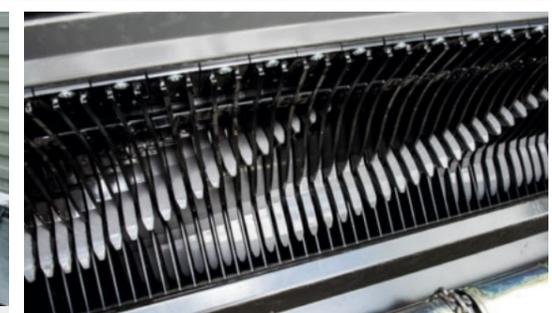
Der Rotor mit 800 mm Durchmesser und sieben spiralförmigen Zinkenreihen aus Hardox-Stahl ist auf beiden Seiten mit groß dimensionierten Pendelrollenlagern ausgerüstet.
