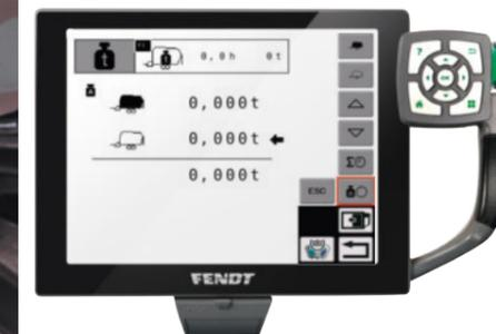
Das bei den hydropneumatischen Fahrwerken optional integrierte Wiegesystem zeigt Ihnen den Ernteertrag bequem in Ihrer Kabine an. Somit behalten Sie die ständige Kontrolle über das Gewicht und die Zuladung.
