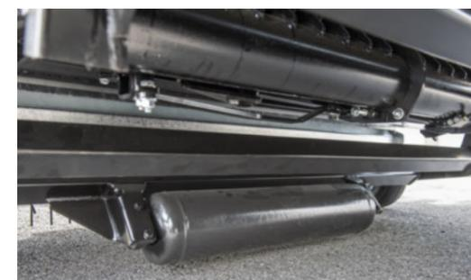
Die mittig hinter der Pick-Up platzierte Tastrolle hält den eingestellten Bodenabstand kontinuierlich ein und gewährleistet auch bei schwierigen Bodenverhältnissen ein sicheres Führen der Pick-Up.
