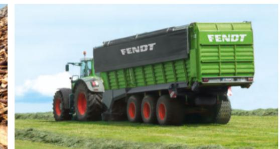
Die hydraulische Laderaumabdeckung ist ganz einfach über das Terminal zu bedienen.
