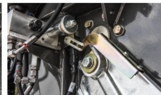
Die Knickdeichsel-Lageregelung sorgt dafür, dass der eingestellte Öffnungswinkel der Pick-Up automatisch gehalten und geregelt wird. Das garantiert einen gleichbleibenden und konstanten Gutfluss ohne Verengungen und eine saubere Recharbeit auch in kuppertem Gelände.
