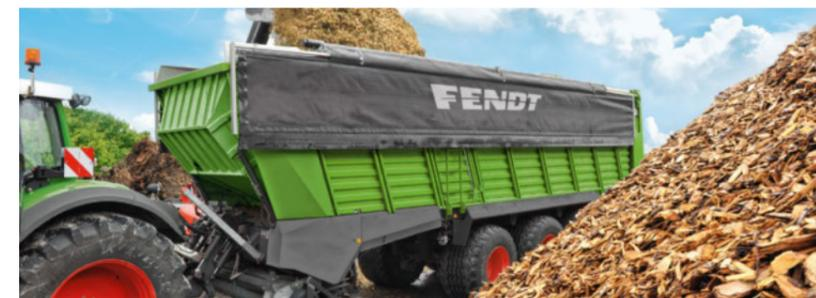
Der Aufbau ohne Rohrbügel des Fendt Tigo erlaubt ein einfaches Befüllen von oben, egal ob mit der Schaufel oder dem Häckslers.
