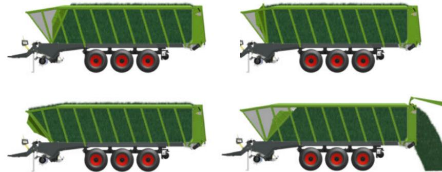
VarioFill: Die Kombination aus intelligenter Auf- und Abladeautomatik und Multifunktionsstirnwand.
