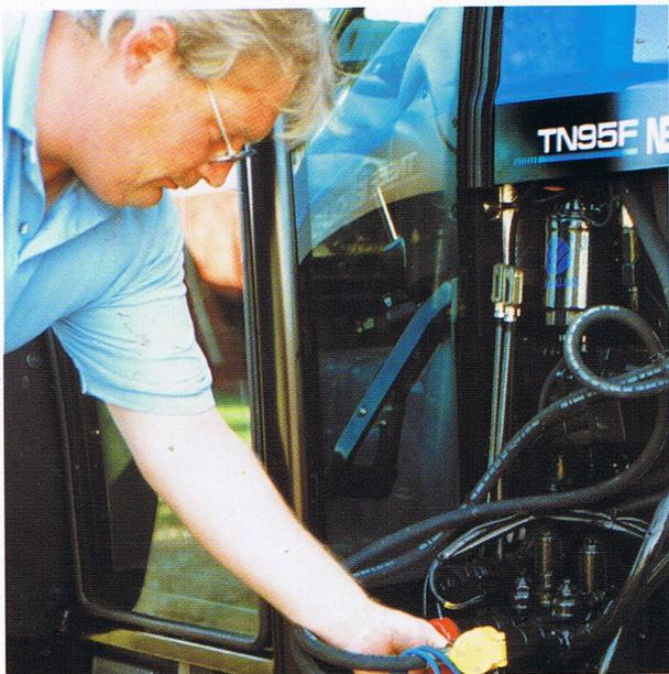
Die Traktoren der Serie TNF lassen hinsichtlich Hydraulikleistung keine Wünsche offen. Hochleistungsfähige Hydraulikpumpen sind Bestandteil der Serie TNF. Die Pumpe, die die Lenkung und den Steuerkreis separat mit Öl versorgt, bietet genügend Förderleistung auch bei niedriger Drehzahl. Die MegaFlow™-Hydraulikpumpe versorgt den bzw.
