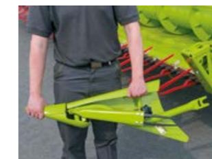
Remplacement simple et rapide des diviseurs
