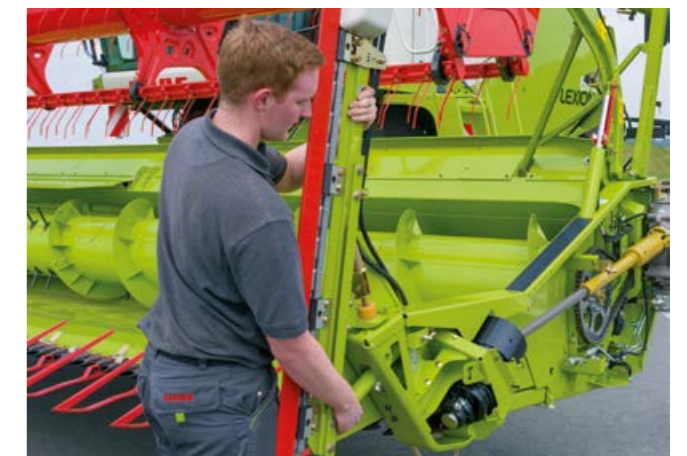
Système de verrouillage rapide pour le montage des scies à colza
