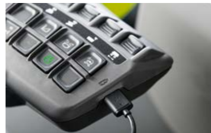
Une prise USB 12 V est prévue pour l'alimentation électrique d'appareils électroniques.
