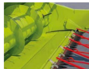
Tablier de coupe sorti - mode céréales (+ 100 mm)
