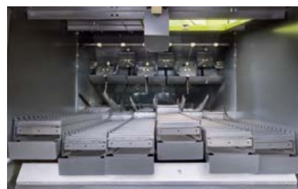
Vue arrière sur les secoueurs
