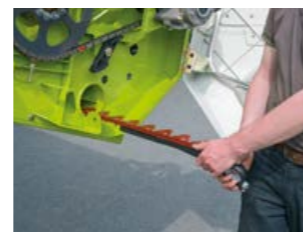
Scie de rechange logée en bas de la barre de coupe
