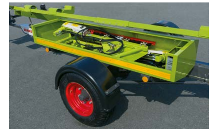
Coffre pour le transport de l'équipement colza
