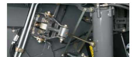
Commande hydraulique de la compensation de dévers 3D
