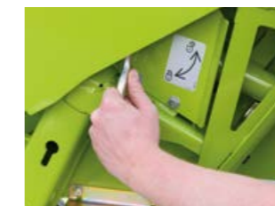
Système de verrouillage rapide des diviseurs
