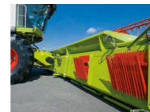
Supports de rangement sur la coupe pour releveurs d'épis
