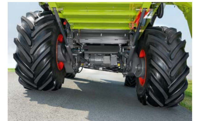
Essieu avant MONTANA avec débattement maximal
