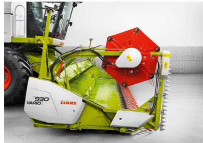
Tablier de coupe sorti - avec scies à colza (+ 600 mm)
