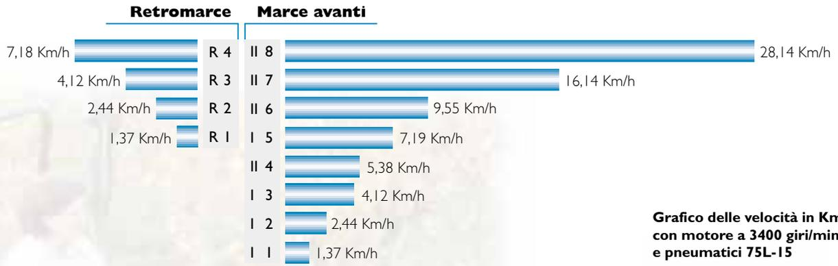
Grafico delle velocità in Km/h con motore a 3400 giri/min e pneumatici 75L-15
