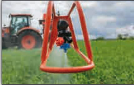
Spezielles Bodenprofil für volle Integration und Schutz der Düsen.
