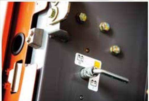
El interruptor de desconexión aumenta la seguridad durante los trabajos de mantenimiento.
